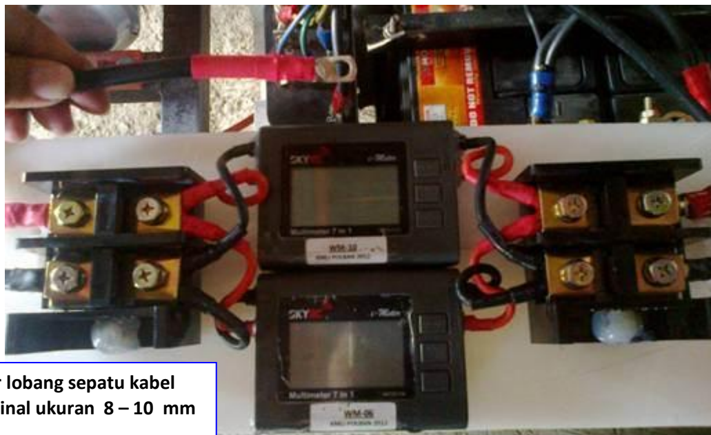
Gambar 1. Konstruksi Dua Watt-hour meter terpasang secara paralel, terminal dan sepatu kabelnya.
